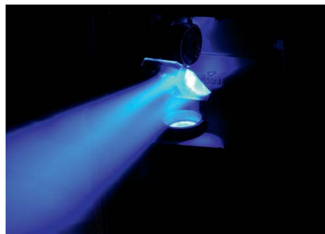
Abb. 10: Der blaue Laser mit einer Wellenlänge von 405 nm
